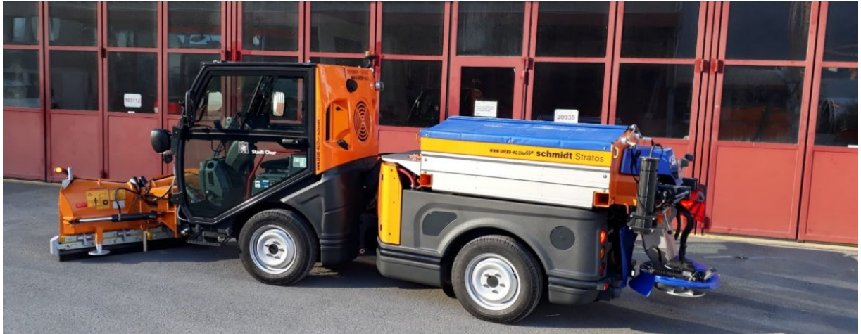
Neues Kommunalfahrzeug Schmidt/Flexigo mit Thermokamera (Röhre hinten am Salzstreuer)
