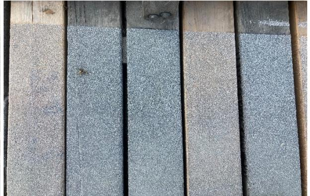
Antirutschbelag mit Zweikomponentenkleber, abgestreut mit Quarzsand
