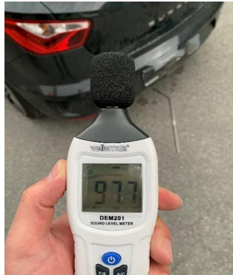
Lärmmessung bei einer technischen Fahrzeugkontrolle
