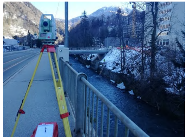
Aufnahme digitales Geländemodell Plessur bei Bodmerbrücke
