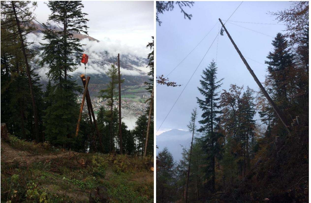
Mittels Seilkran mit mobilen Stützen mit über 25 m Seilhöhe wird das Holz aus den Hängen am Pizokel transportiert
