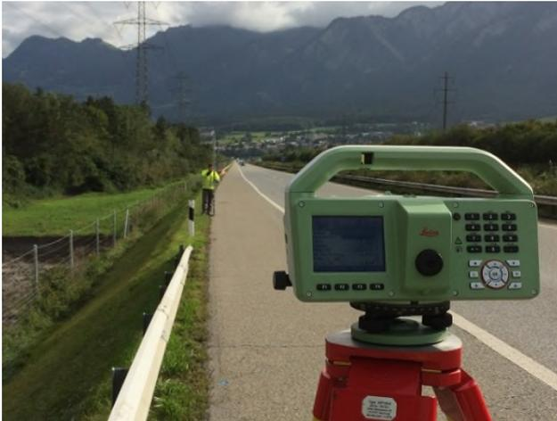
Setzungsmessung / Präzisionsnivellement N13
