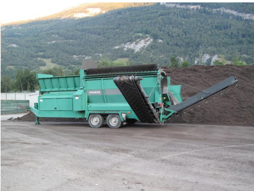
Siebmaschine mit neuem Trommelsieb für 15 mm Kompost
