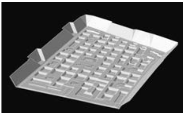
Rheinfels III, 3D Aushubmodell für GPS Baggersteuerung.
