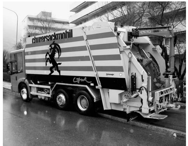
Kehrichtwagen mit Kranaufbau zur Leerung der Molok.
