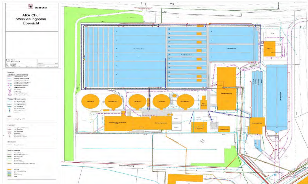
Übersichtsplan der Werkleitungen auf dem Areal der ARA Chur
