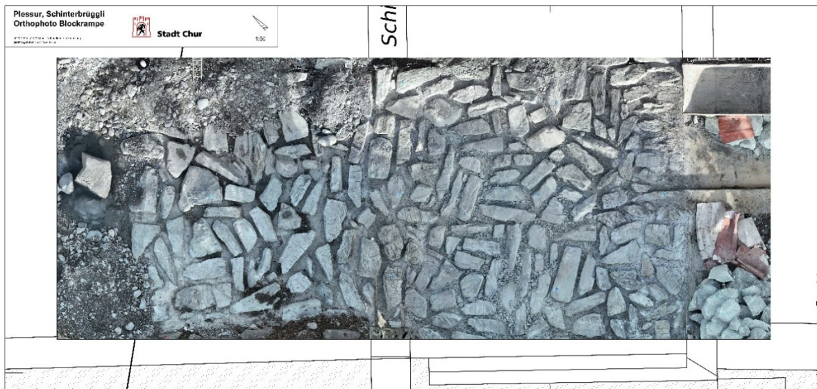
Drohnenflug: Bestandesaufnahme und Erstellung georeferenziertes Orthophoto für Blockrampe Plessur
