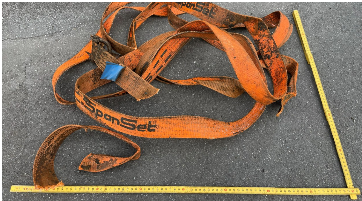
Von der Förderschnecke im Annahmehunker entferntes Spanset
