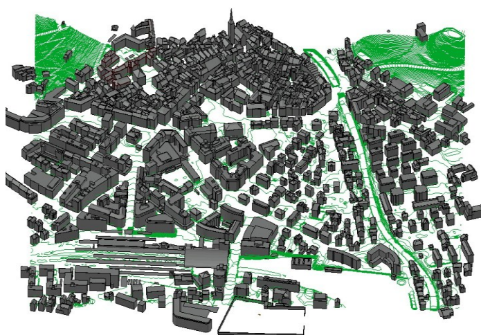
3D Daten Zentrum-Altstadt Chur: Kombination LIDAR Höhenkurven mit Gebäude SwissBUILDINGS3D
