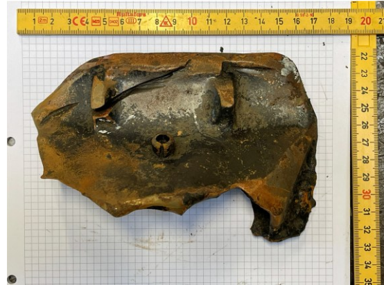
Entfernter Fremdkörper (Metall) aus verschlissener Schlammpumpe PM1620 Annahmehunker
