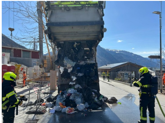
Brand in einem Kehrrichtwagen durch unsachgemäss entsorgten Fahrradakku
