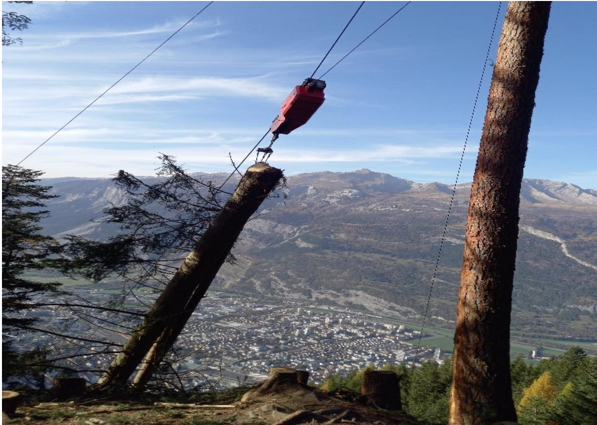
Holzernte mit Seilkrananlage im Gebiet Fürstenbrunnen
