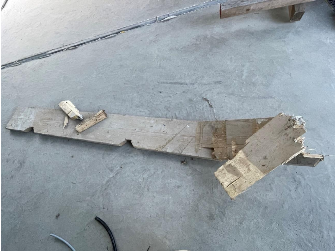
Gerüstbrett im Umlaufrechen führte zum Unterbruch der Zulaufstrasse 1
