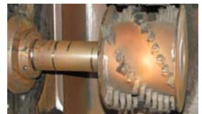
*Der Schlamm eintrag in den Trockner. Mit solchen Zerteilerwalzen wird der Schlamm zerkleinert und in die Wirbelschicht eingetragen. Selbst mit Hartmetall bestückte Zähne halten dem Schlamm auf die Dauer nicht stand und müssen regelmässig erneuert werden.*
