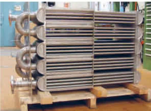
Fabrikneuer Wärmetauscher vor dem Einbau
