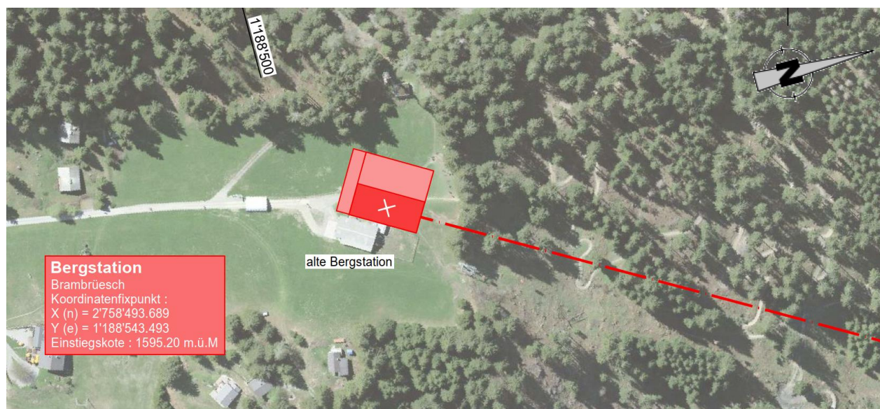
Abb.6: Standort der neuen Bergstation (Quelle: Bauspektrum)
