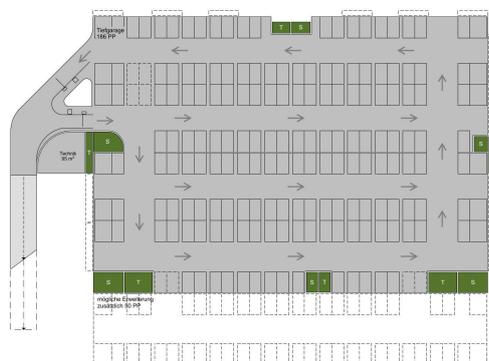
Abbildung 6: Grundriss Tiefgarage [Ritter Schumacher AG Architekten ETH HTL AA SIA, 26.02.2020]
