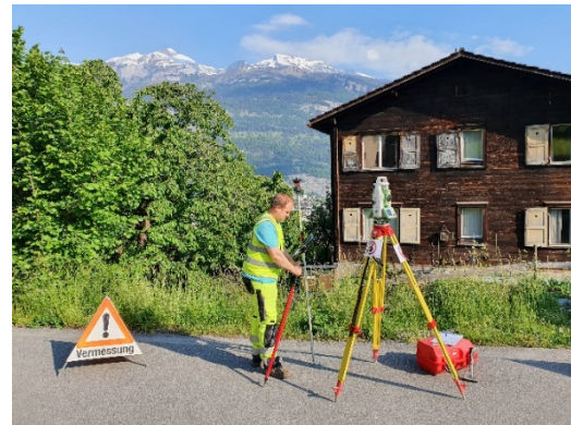
Absteckung Grenze, Hirschbühlweg Chur
