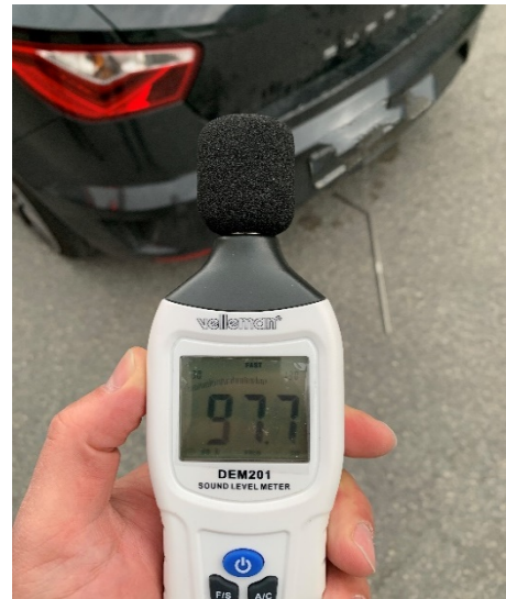
Lärmmessung bei einer technischen Fahrzeugkontrolle
