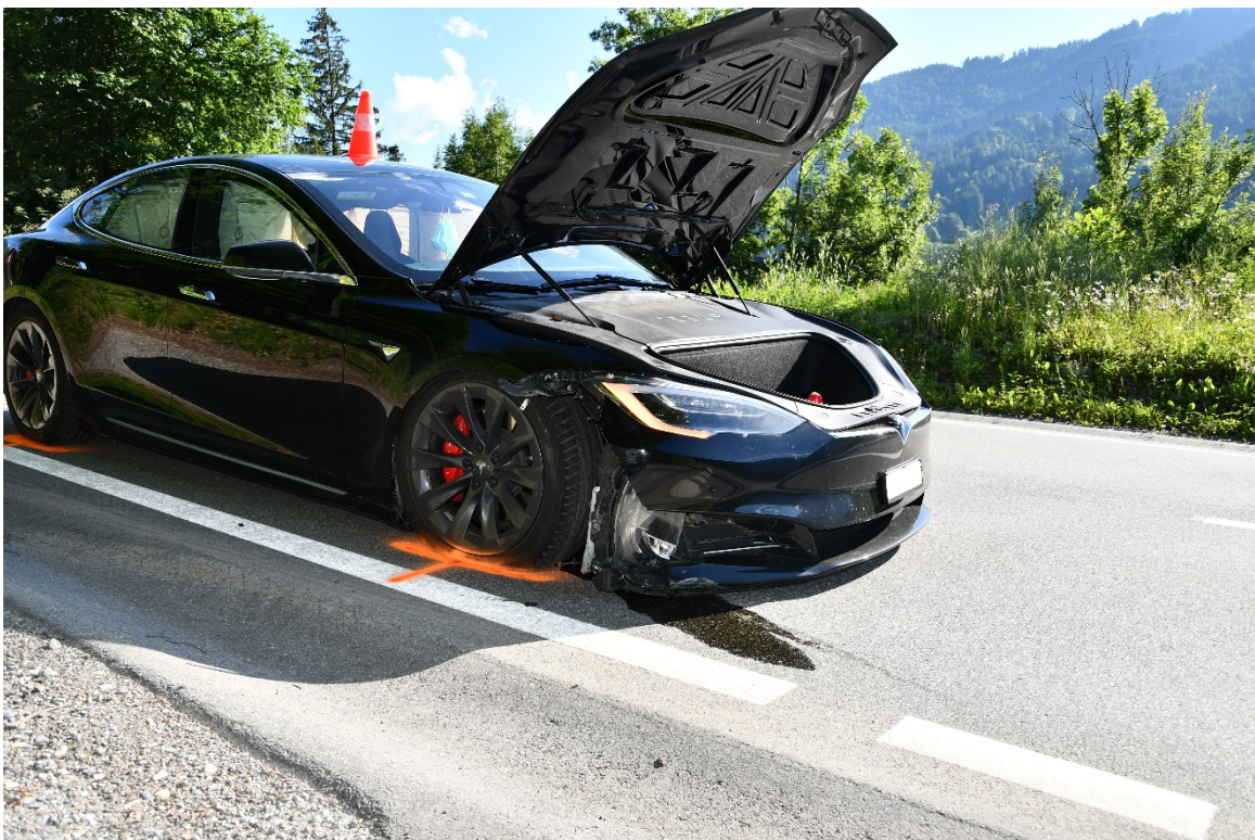
Unfall eines Elektrofahrzeugs (Hochvolt-Fahrzeug). Markiert werden diese Fahrzeuge jeweils mit einem Kegel auf dem Dach. Zunehmend wird die Feuerwehr nach Unfällen mit Elektro-/Hybridfahrzeugen zwecks Brandschutz und Stromlosmachen aufgeboten.
