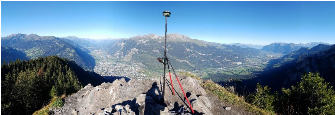
GNSS Fixpunktemessung auf dem Fühörnli (Entzerrungsarbeiten)
