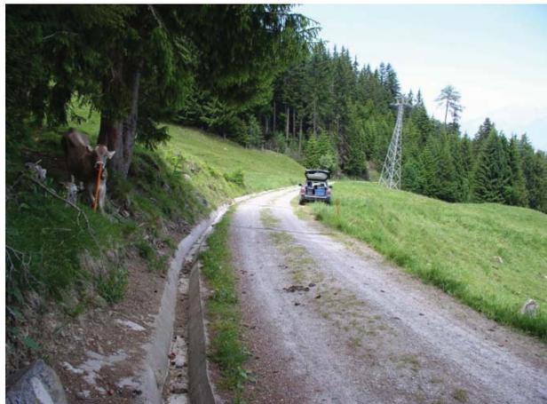
BD 5 Einzelstellen an Strassenrand, Strassenschulter, berg- und talseits, 150 Uranin, je 300l gespült, Abfluss zumeist über Rigole bis in Querschlag und Versickerung
