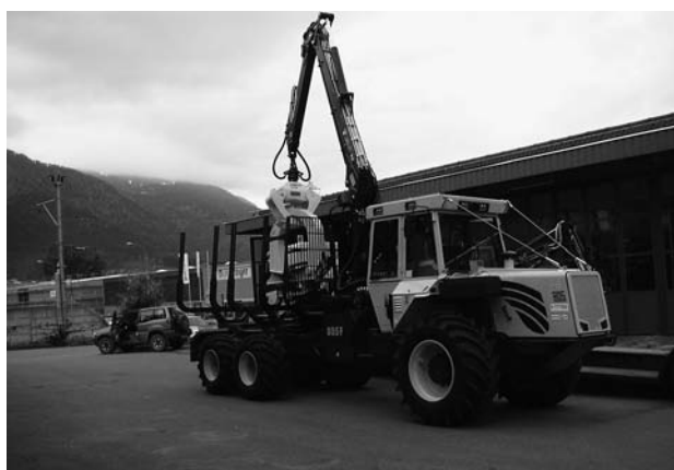
Der neue 6 Rad Kombiforstschlepper mit Knicklenkung, Seilwinde, Kran, Rungenaufbau und Klemmbank.
