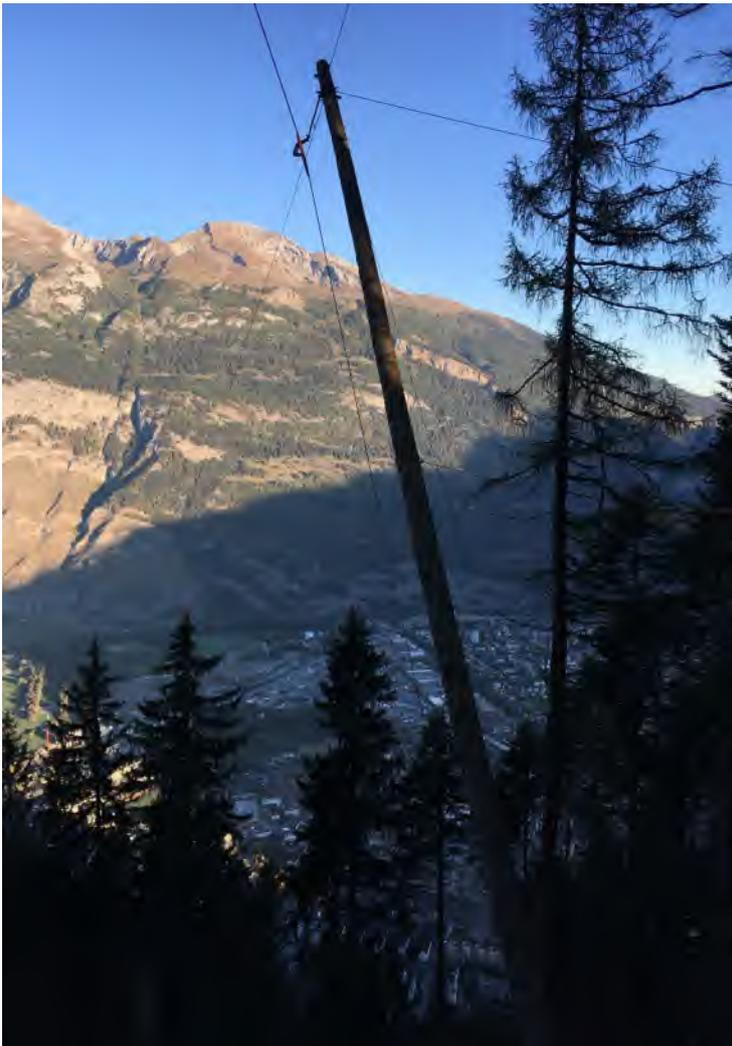
In den steilen Schutzwäldern rund um Chur wird ein Grossteil des Holzes mittels Seilkran an die Waldstrassen transportiert. Acht solcher temporären Seilbahnen wurden im Berichtsjahr in Chur auf- und abgebaut. Diese Art von Holzbringung ist schonend für den Waldboden und den Bestand, dafür aber aufwändig.
