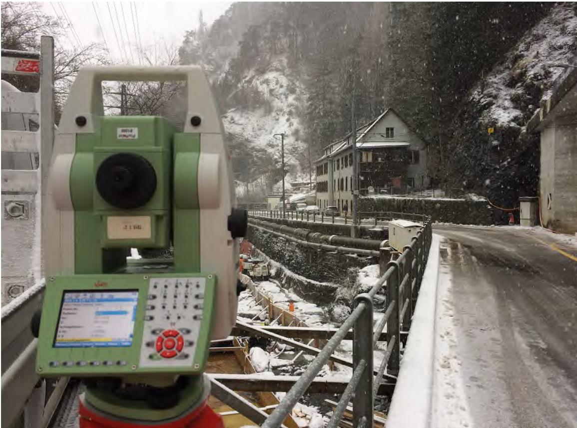
Tachymetrische Überwachungsmessung der Wuhrmauer Sandstrasse
