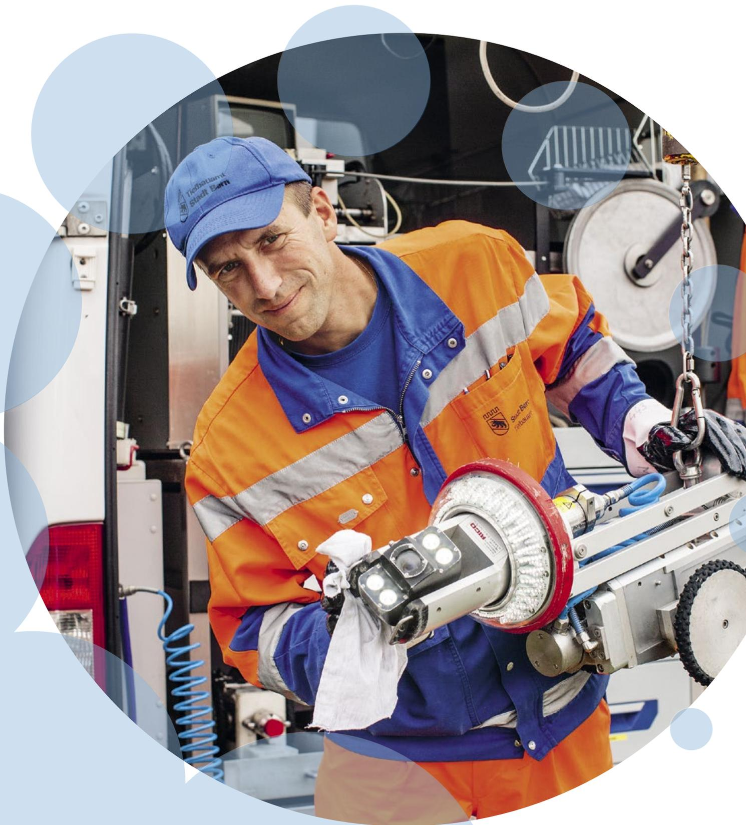
« Mit diesem Roboter inspizieren wir unser Kanalnetz regelmässig auf Schäden. So können wir der Verschmutzung von Boden und Grundwasser vorbeugen und längerfristige Unterhaltmassnahmen planen. »
